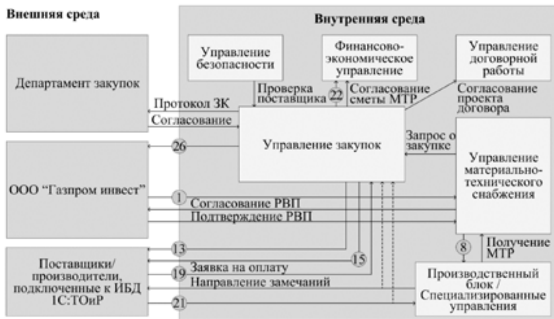
Рис. 1. Взаимодействие структурных подразделений Общества и внешней среды при предлагаемой модели проведения закупок МТР
